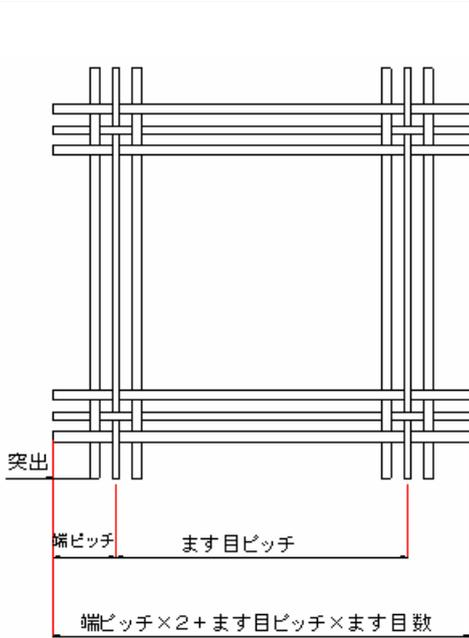
図A-1 平線4mm 正方形
