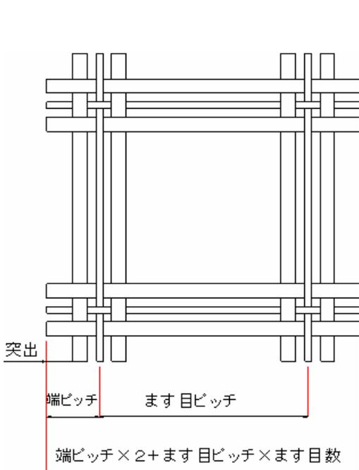
図B-1 平線8.5mm 正方形
